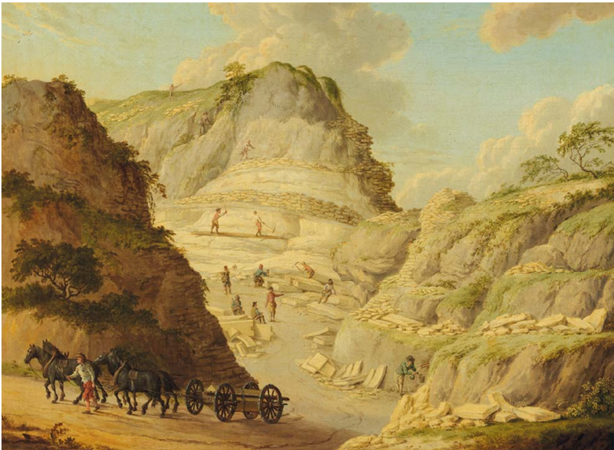
AFBEELDING 17. | Schilderij van een anonieme schilder uit de tweede helft van de 18e eeuw, met daarop een afbeelding van de werkzaamheden in één van de groeves in Bentheim. Op verschillende plaatsen zijn de groeewanden met stenen muurtjes versterkt. Vooraan liggen grote blokken, die als bouwsteen zijn bedoeld. Direct achter de heuvel met paard en wagen ervoor liggen reeds gehakte bouwonderdelen, waaronder een boogfragment. Collectie Rijksmuseum Twenthe; Enschede; fotografie R. Klein Gotink © Rijksmuseum Twenthe.
