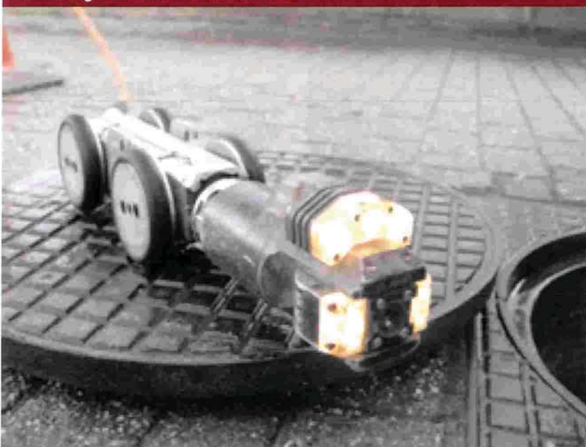
Onder: De robot toont het verborgen leven in ondergrondse rioolstelsels. De camera zit in de kop van de robot, tussen de lampen. De camerakop kan 360 graden rond draaien in het verticale vlak. Tijdens de rit door de riolen sleept het karretje de kabel achter zich aan, die de verbinding vormt tussen de robot en de opnameapparatuur die zich in een controlewagen bevindt. FOTO: FONS BONGERS
