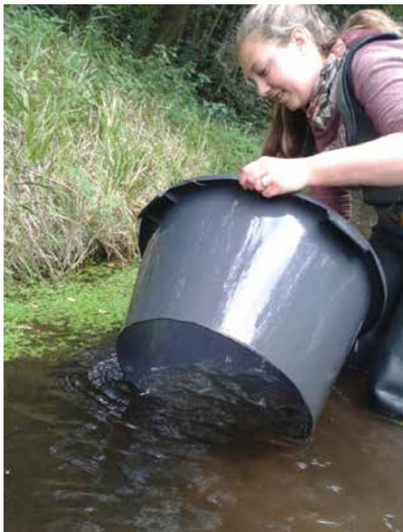
Vrijwilligster aan de slag met een prikkencilinder. Deze wordt gebruikt voor het nemen van een steekmonster met vaste oppervlakte voor onderzoek naar de larvendichtheid van beekprikken. (Foto: Frank Spikmans)
