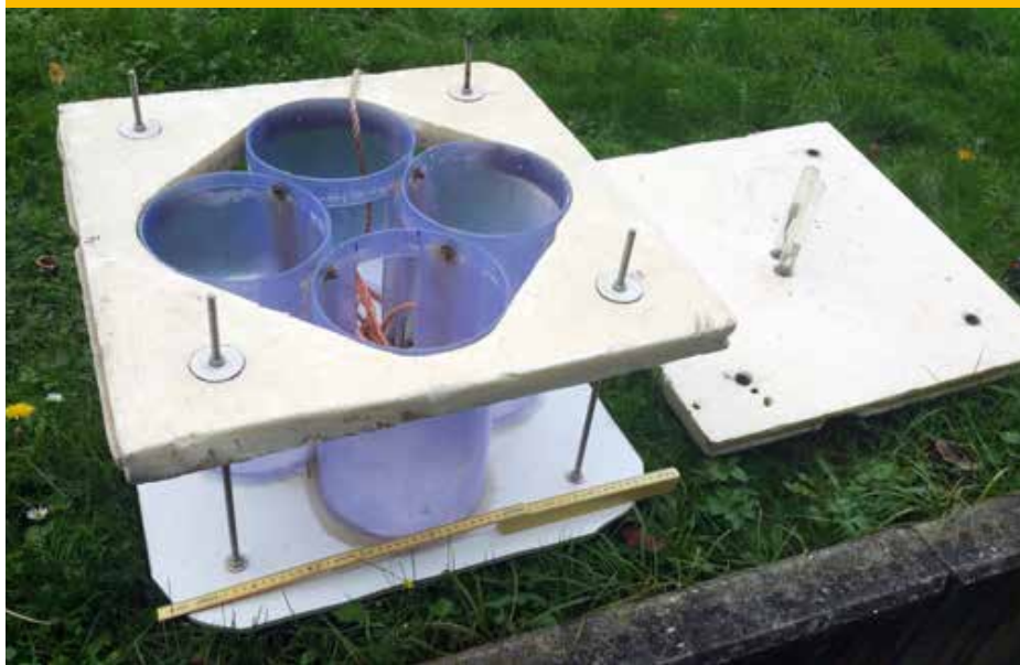
Figuur 4. Een lichtfuik voor het bemonsteren van fototactische vislarven (aangepaste variant van het INBO) blijkt zeer efficiënt te zijn. Op de foto is de lichtval te zien met een opengeklapt deksel met daarin de lichtbron. (Foto: Johan Auwerx)
